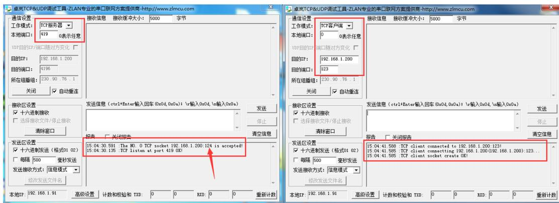
注意：设备作为 TCP 客户端的本地端口 = 设备作为 TCP 服务器的监听端口 + 1，如上图箭头所示。
