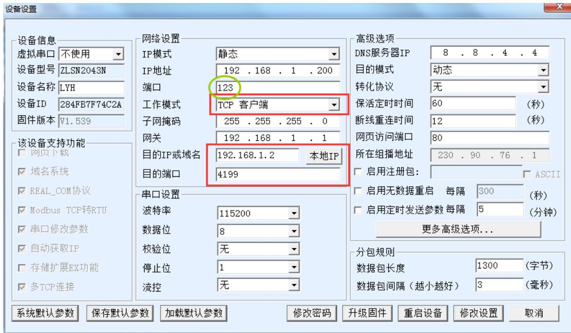
这样，设备既做客户端连接到目的 IP 的目的端口，又做服务器在本地端口监听。用两个网络调试助手可以分别做服务器接受设备的连接和做客户端主动连接设备，如下：
